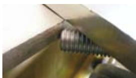
**Arresti meccanici integrati:** Gli operatori ELI250N dispongono di arresti meccanici regolabili integrati nelle leve di trasmissione del moto. Questo permette di non dover installare delle battute a pavimento per arrestare l'anta in posizione di chiusura e di apertura.
